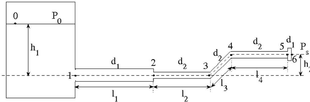
Schéma du circuit hydraulique.
