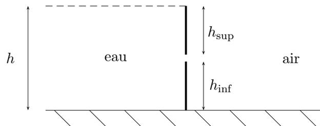
Nous souhaitons que chaque panneau supporte le même effort. La hauteur du panneau supérieur est notée  $h_{\text{sup}}$ , celle du panneau inférieur  $h_{\text{inf}}$  et les altitudes des centres de poussée sont notés  $\lambda_{\text{sup}}$  et  $\lambda_{\text{inf}}$ .
