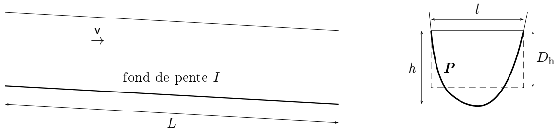
FIGURE 6.2 – Ecoulement permanent uniforme avec pente constante.
